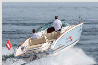
Von einer Rennmaschine zu sprechen, wäre vermessen. Mit welcher Stabilität die gerade mal knapp 8,5 m lange Cormate T-27 im Wasser liegt, ist jedoch bemerkenswert. Da können nur wenige Sportboote in dieser Klasse mithalten. Passend zur Stabilität des Rumpfes ist das Boot mit einer High-Performance-Steuerung (nur etwas mehr als zwei Umdrehungen) und mit zwei getrennten Gas- und Schalthebeln (DTS Zero Effort Digital Control von Mercury) ausgestattet. Ein bisschen Rennfeeling gibts also doch...
