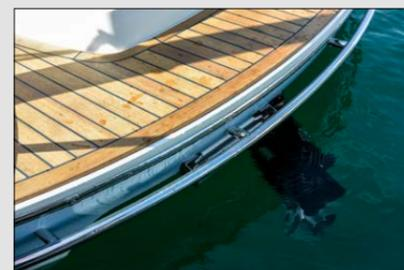
Die Cormate T-27 überzeugt mit guter Bauqualität und einem gepflegten Finish. Zudem bietet sie einige bemerkenswerte Details: Die abgerundete Badeplattform wird von einem im gleichen Radius gebogenen Chromstahlhandlauf geschützt. Bei den Treibstoff- und Wassertank-Deckeln ist das entsprechende Symbol eingraviert. Und auf den Motorraum-Lüftungsdeckeln aus Chromstahl ist das Cormate-Logo ebenfalls sauber eingraviert. Die Aufzählung liesse sich verlängern... Die T-27 bietet viel Boot fürs Geld.
