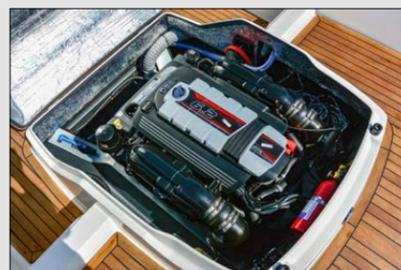
Das Testboot war mit einem MerCruiser 6.2L ausgestattet. Der V8-Benziner leistet 350 PS und passt perfekt zum Konzept der Cormate T-27. Das Boot beschleunigt rassig und die Spitzengeschwindigkeit liegt bei 90 km/h. Eine angenehme Reisegeschwindigkeit von rund 40 km/h wird schon bei 2800 U/min erreicht. Bemerkenswert ist die Konstruktion des Motorraums: Der Motor befindet sich direkt unter der komplett aufklappbaren Sitz- und Liegekombination des Cockpits und ist entsprechend gut zugänglich.
